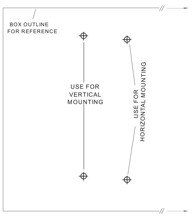
WML1U DRILLING TEMPLATE USE No8 ROUND HEAD SCREWS
